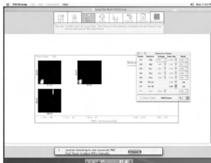
6、在 PMT 窗口下：用“管 1”为样品，点击「Start」自动调节光电倍增管的电压，屏幕出现闪烁“PMTs Set Successfully”，便可点击「Next」。
