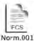
1. 点阵排列的数据文件 (list-mode data file) --是由没有处理的原始数据构成的数据文件。其中包括每个微粒 (点) 的所有测量参数，和一些对样本的描述。由BD FACStation软件创建的数据文件是FCS 2.0的格式。FACStation软件程序能分析BD FCS 2.0文件。
