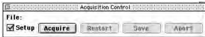
点击 Acquire，此时软件开始自动按照显示的路径和文件名保存数据。直到采集到 15,000 个细胞后，会听到“嘟”的一声，软件自动停止保存。采集过程中，可以从 Acquire 菜单下打开 Counter 窗口，实时了解已经采集的细胞数。
